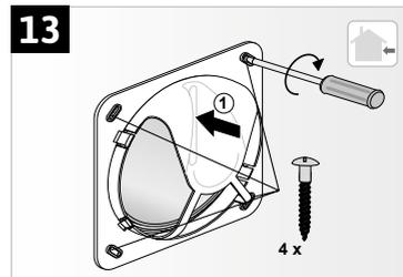
Im nächsten Schritt setzen Sie bitte die Außenblende [7] mit der geschlossenen Kante nach oben auf den Wandanschluss – achten Sie dabei darauf, dass die Schnappverbindungen einrasten (Abb. 14).
