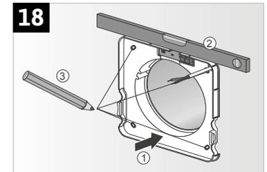
Bohren Sie jetzt die Löcher und versehen Sie diese mit für die Wandbeschaffenheit passenden Dübeln. Setzen Sie dann den Wandanschluss wieder auf das Wanddurchführungsrohr, achten Sie dabei auf den richtigen Sitz und dass die Kabelführung durch die dafür vorgesehene Öffnung verläuft. Befestigen Sie nun den Wandanschluss mit vier Schrauben an der Wand (Abb. 19).
