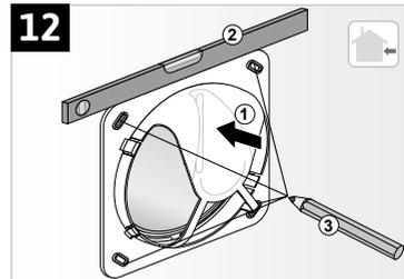
Achten Sie hierbei auf den richtigen Sitz des Wandanschlusses und kontrollieren Sie diesen mit einer Wasserwaage. Nehmen Sie den Wandanschluss wieder von dem Rohr ab und stecken Sie den Putzstopfen erneut in das Rohr, um zu verhindern, dass Bohrstaub in das Rohr gelangt. Nach dem Bohren der vier Löcher setzen Sie den Wandanschluss wieder auf das Rohr und befestigen ihn mit für die Wandbeschaffenheit passenden Dübeln und Schrauben an der Hauswand (Abb. 13)
