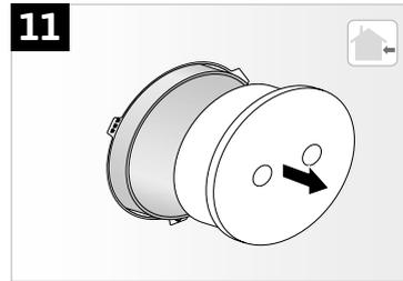
Anschließend nehmen Sie den Wandanschluss [6] von der Außenblende [7] und schieben diesen über das Wanddurchführungsrohr. Nutzen Sie den Wandanschluss als Schablone und zeichnen Sie die Bohrlöcher zur Befestigung an (Abb. 12).
